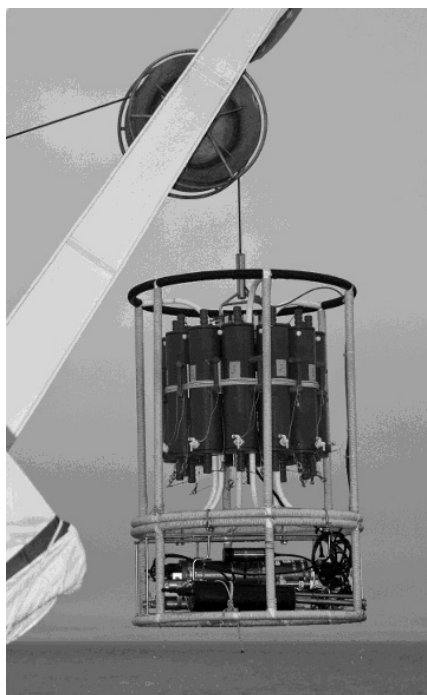
Рисунок 8.1 – CTD-зонд SBE 19plus на розетке с батометрами перед погружением в воду
